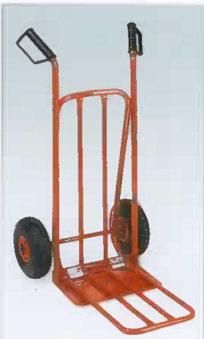
MOD. 122M1163 PORTATA Kg 150 PESO Kg 12,6 RUOTE PNEUS Ø 260 L= 540 D=490 H=1080 G=380/310 P=210/530
