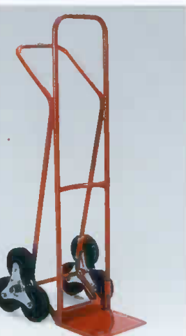
MOD. 120M583 PORTATA Kg 150 PESO Kg 12,2 RUOTE 6 PIENE Ø 160 L= 500 D=590 H=1340 G=300 P=250
