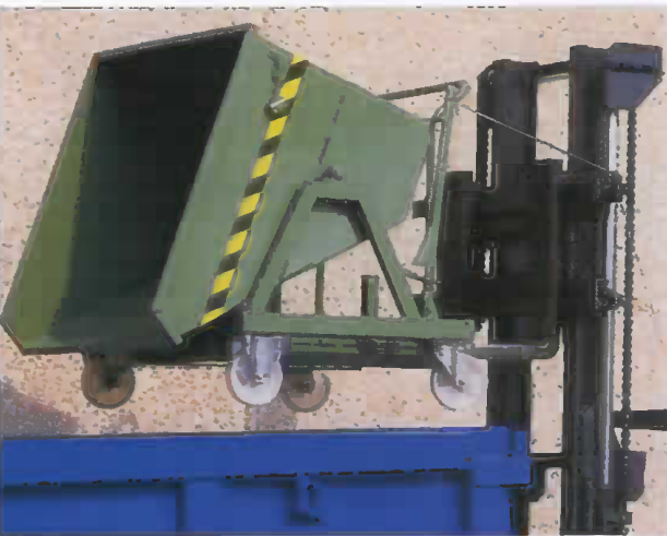
MOD. 630 BENNA RIBALTABILE RUOTE Ø175 IN NYLON VASCA A TENUTA STAGNA
