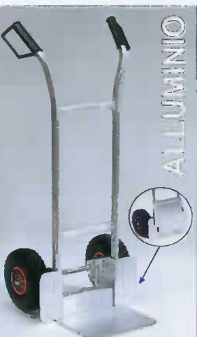
MOD. 111M610 PORTATA Kg 150 PESO Kg 9 RUOTE PNEUS Ø 260 L= 450 D=500 H=1150 G=300 P=270
